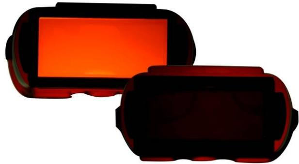
Arriba: Fluorescencia visible de unas gafas de observación sin recubrimiento bajo una luz de alta intensidad.
