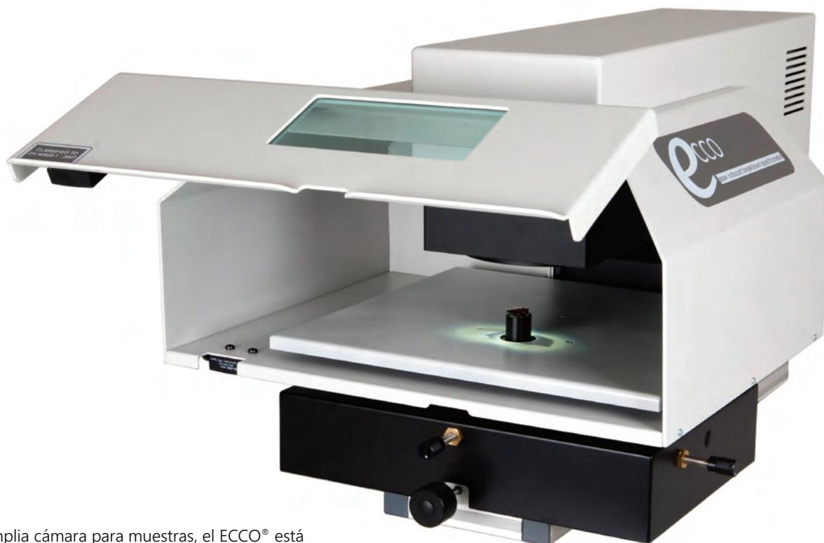
Provisto de una amplia cámara para muestras, el ECCO® está diseñado para el análisis de papel, cristal, metales, pintura, fibras, minerales y residuos de disparo mediante espectroscopía de sublimación inducida por láser (LIBS) permitiendo el análisis elemental en materiales tan pequeños como 300 micras.
