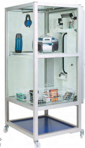
*Evidencias colocadas dentro de la cabina de revelado MVC®3000.*
