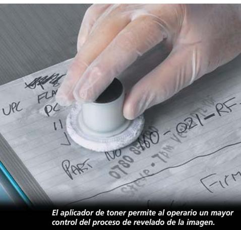
El aplicador de toner permite al operario un mayor control del proceso de revelado de la imagen.
